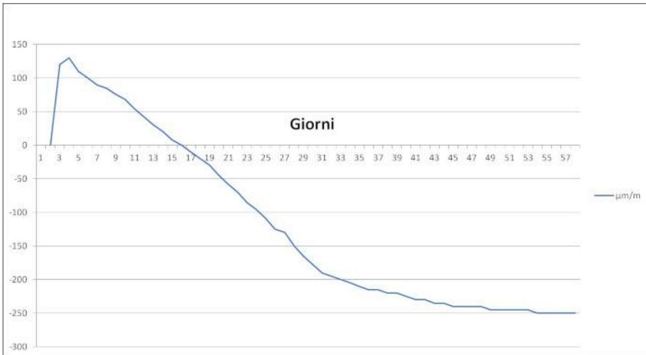
Test di espansione/ritiro del calcestruzzo con aggiunta di Dry D1 NG al dosaggio consigliato
